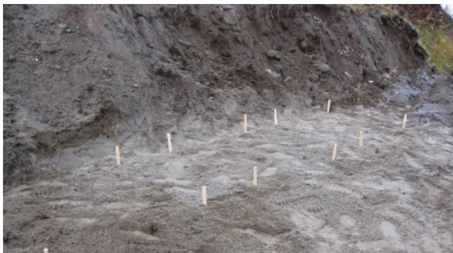
Рис. 19. По периметру участка были сформированы 18 делянок, каждая площадью 1 м 2 . Фото Л. А. Ивановой
