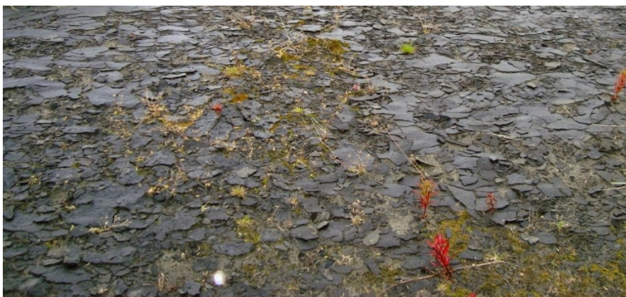
Рис. 8. Результат применения анионной битумной эмульсии для пылеподавления на резервном хвостохранилище АНОФ-2. Фото Л. А. Ивановой
