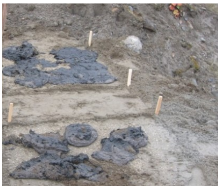
Рис. 20. Фрагментарное нанесение слоя из ОСВ на опытных делянках. Фото Л. А. Ивановой
